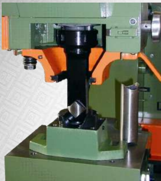
Herramientas para entallado de tubo para uniones a 90°. Hasta tubo de 60 mm Ø
