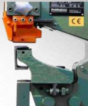
Portamatrix cuello cisne para el punzonado de perfiles
