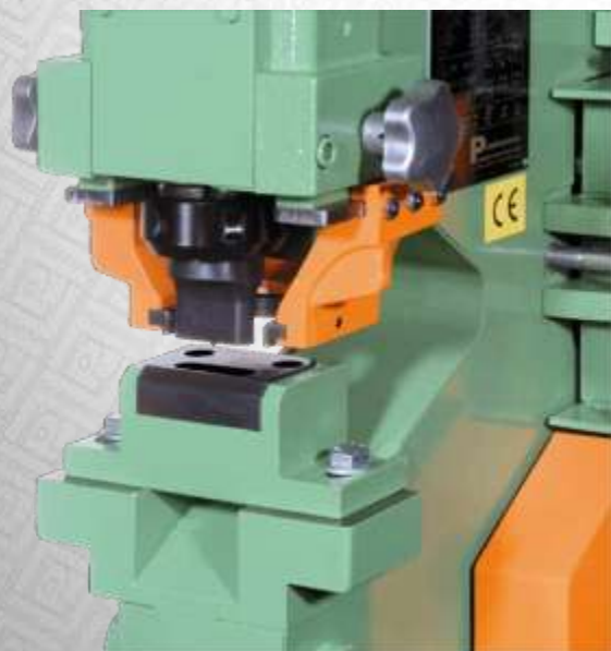
Para punzonar oblongos en perfiles angulares Longitudinal o transversal
