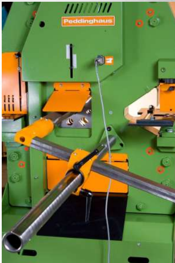
Tope eléctrico de longitud para todas las estaciones de trabajo de 1, 2, o 3 metros.
